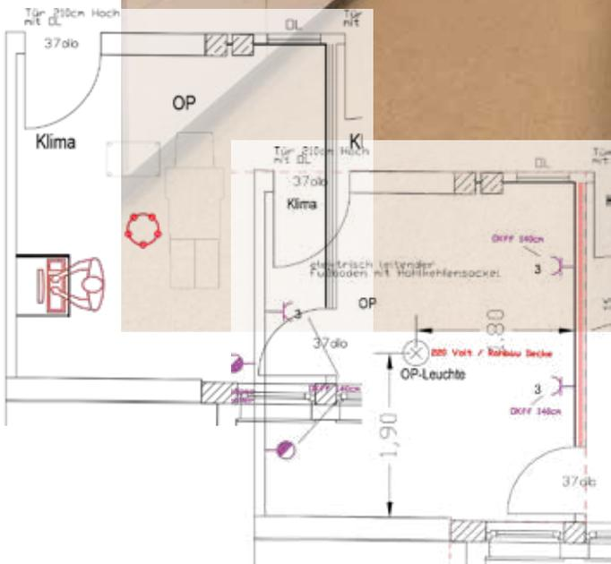
**Mitte:** Im OP sind die Hängeschränke nach oben geschlossen, die Wände sind gefliest, der Boden ist elektrisch leitend und alle Ecken wurden durch Hohlkehlen verdeckt.
